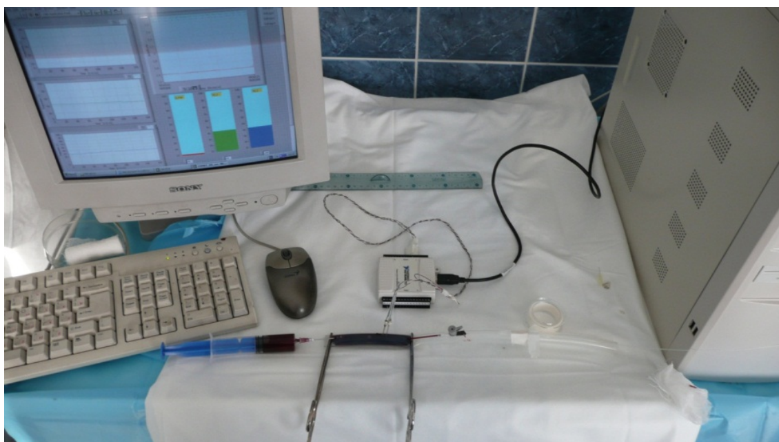
Рисунок 5. Экспериментальный стенд для определения температуры при проведении эндовазальной лазерной облитерации на различных расстояниях от рабочей части световода in vitro при имитации сегмента вены.
